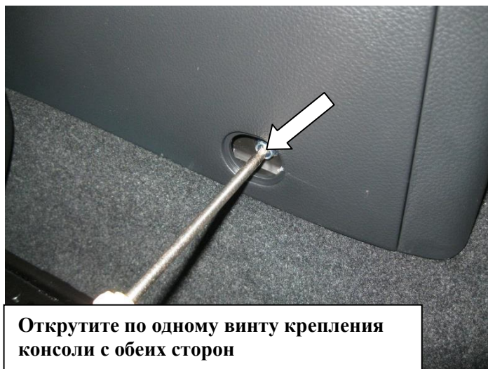
Открутите винт крепления консоли
