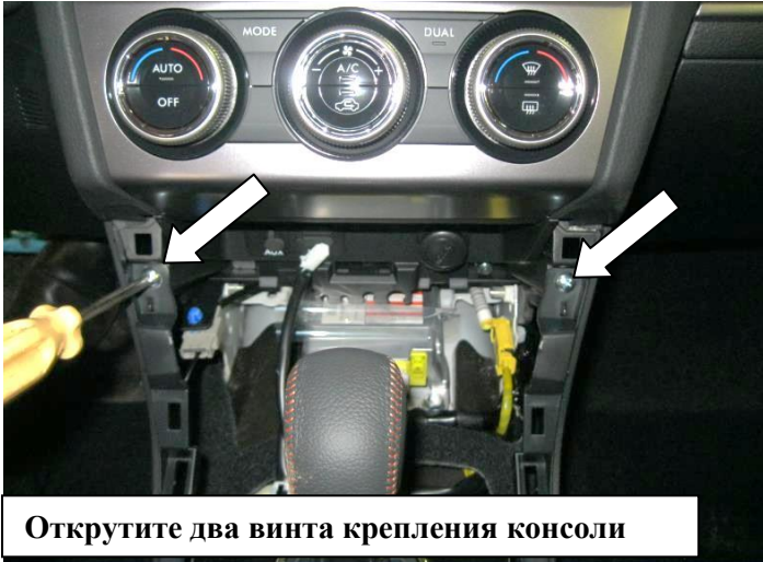
Открутите два винта крепления консоли
