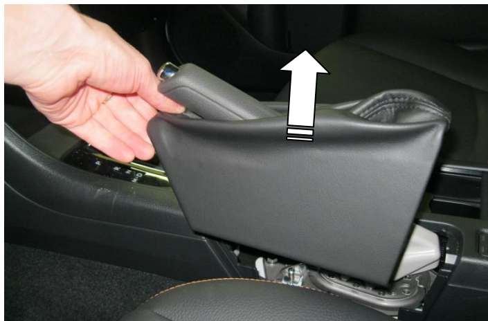
Снимите кожу рычага стояночного тормоза
