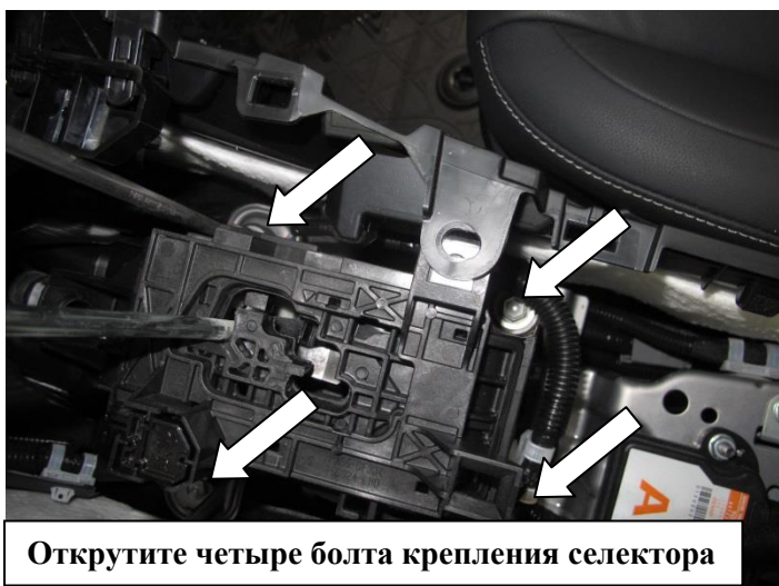
Снимите селектор. Приложите замок (поз. 1) на посадочные места, разметьте и просверлите отверстие ф22 мм в стенке селектора
