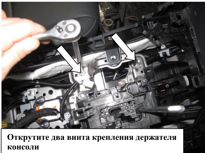
Снимите держатель консоли и подрежьте его
