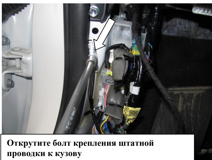
Прикрутите черный провод жгута проводов (поз. 10) с установленной клеммой (поз. 4) к кузову штатным болтом
