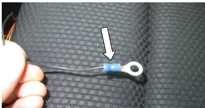
Проведите жгут проводов (поз. 10) от замка (поз. 14) к блоку предохранителей. Установите на черный провод массы жгута проводов (поз. 10) клемму (поз. 4)
