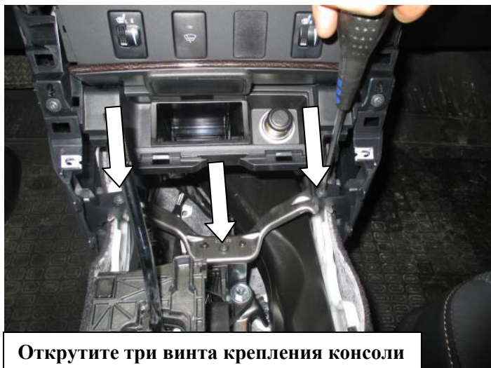
Снимите кронштейн консоли
