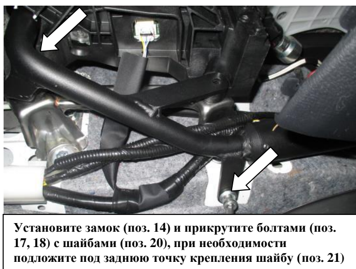
Приложите замок (поз. 14) на посадочные места, разметьте и просверлите отверстие ф22 мм в стенке селектора
