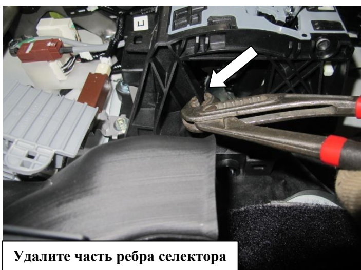
Удалите часть ребра селектора
