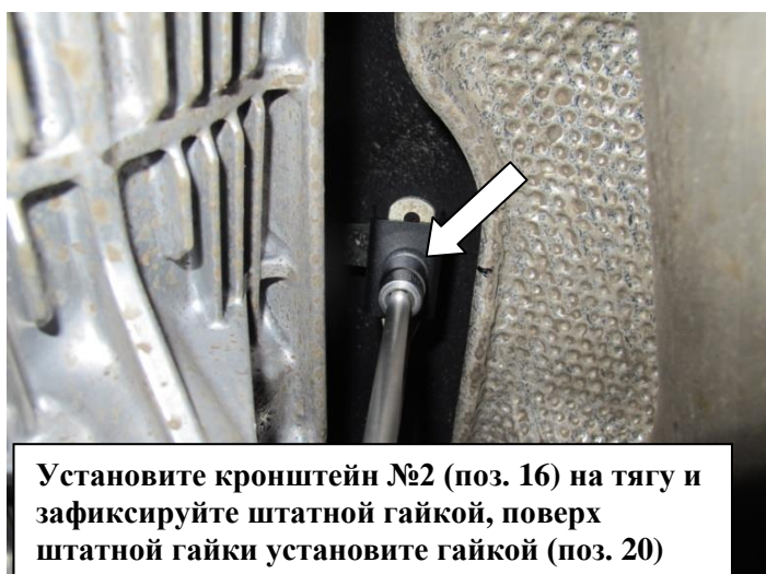
Уставьте поверх штатной гайки крепления тяги КПП, гайку (поз. 20)
