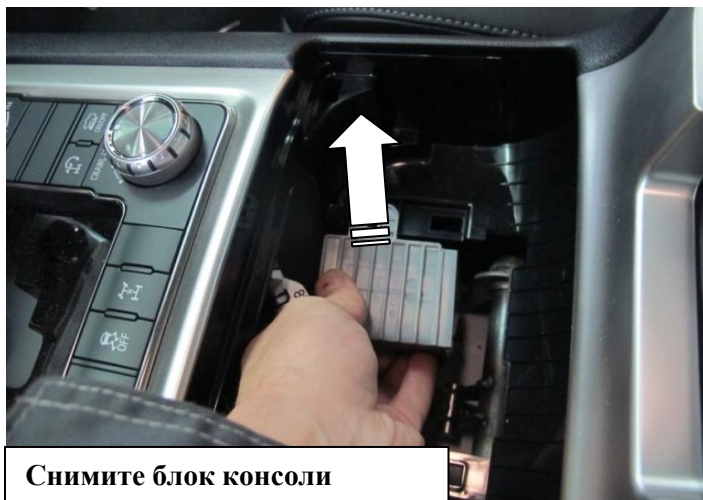
Снимите накладку консоли
