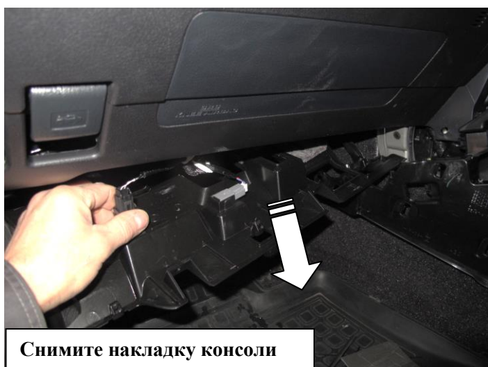
Снимите накладку консоли
