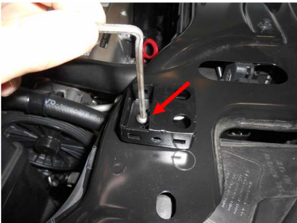
Закрутить винт, используя ключ из комплектации.
