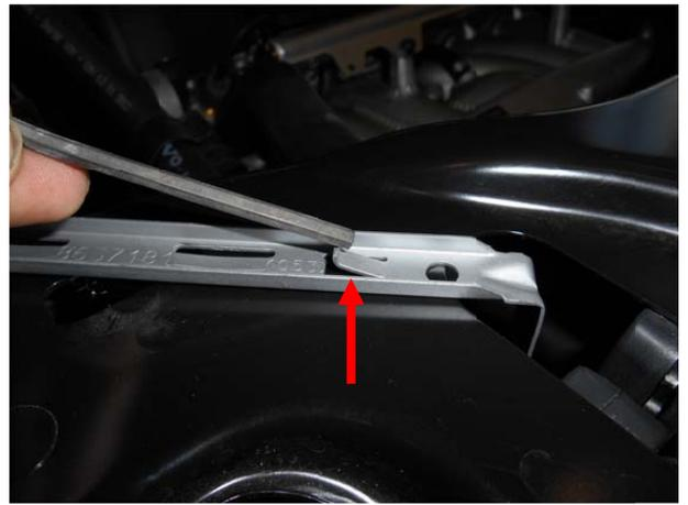
Загнуть ус блокирующего стержня.
