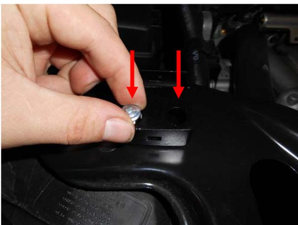
В случае необходимости дополнить крепление корпуса саморезами из комплектации.
