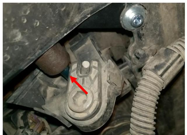
Использовать болт и гайку для крепления нижней точки замка. Отрегулировать положение замка так, чтоб он надежно фиксировал флажок. Установить правую фару на место, защелкнуть рычаг фары до упора. Проверить свободный ход ригеля и надежность блокировки рычага фары блокиратором. При необходимости снять фару и отрегулировать замок.
