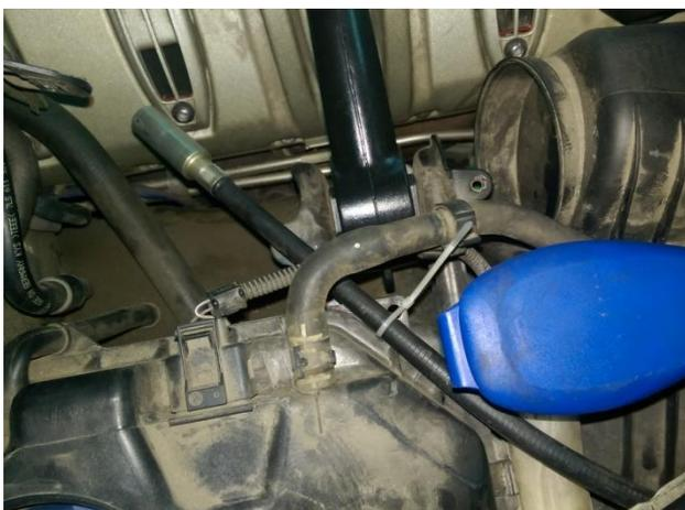
Провести оболочку привода под крылом а/м и зафиксировать с помощью пластиковых хомутов.
