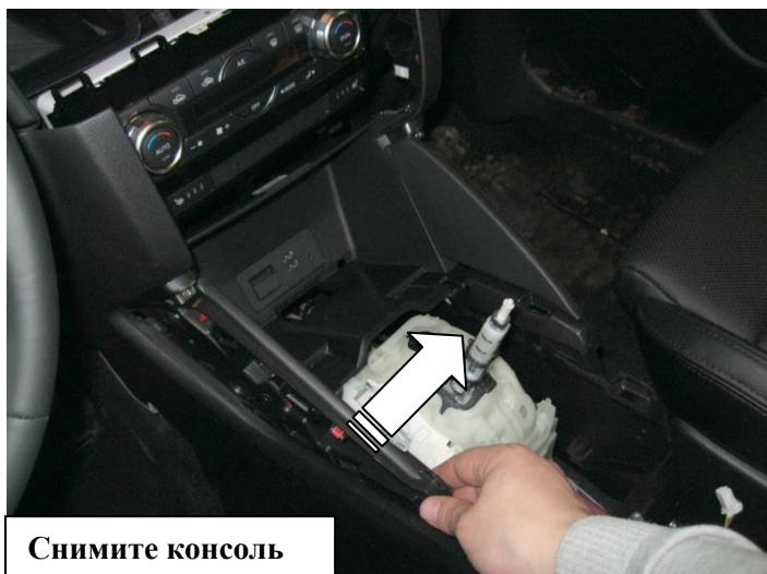
Открутите болт крепления кронштейна консоли
