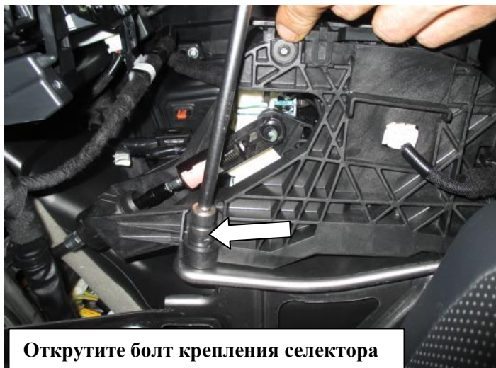
Открутите болт крепления селектора
