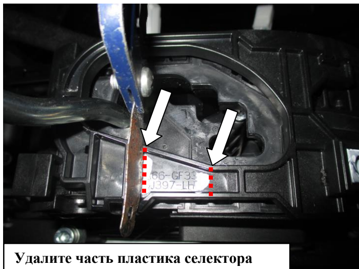
Установите концевик жгута проводов (поз. 10) на селектор так, чтобы рычаг КПП замыкал контакты концевика в положении "Parking". Закрепите концевик жгута проводов (поз. 10) винтами (поз. 6)
