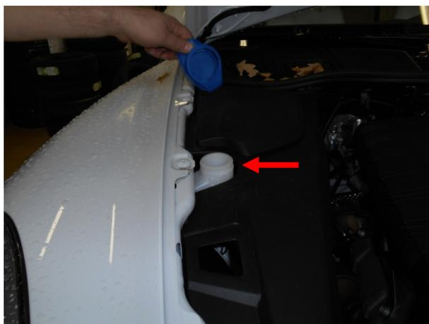
Снять крышку бачка омывающей жидкости.
