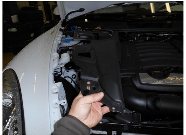
Снять пластиковую панель.
