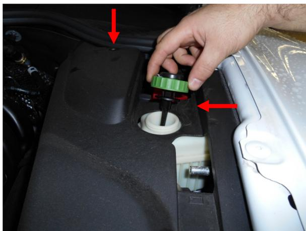
Выкрутить крышку расширительного бачка, вытащить клипсу.
