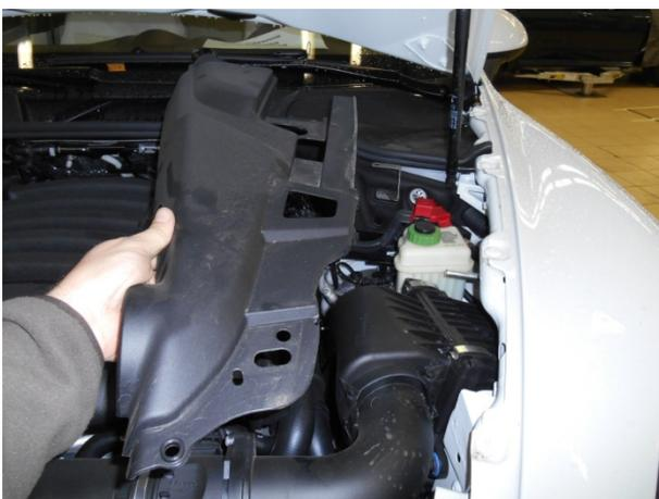
Снять пластиковую панель.
