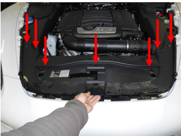
Вытащить клипсы крепления пластиковой панели и снять её.
