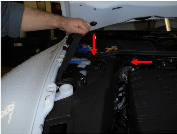
Снять крышку, вытащить клипсу.
